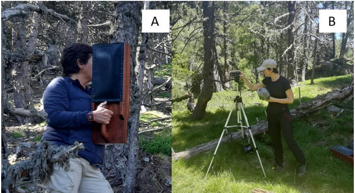
Figura 22. Material emprat durant el mostreig acústic, ambdós situats a 1.5 m d'altura. A) clapet de fusta a cada distància (10 m, 20 m, 40 m i 60 m) , B) micròfon Neve VR i gravadora Zoom F6 al centre de la parcel·la. Font: arxiu propi.
